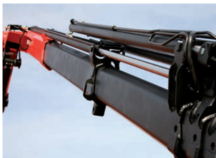
Sistema di sfilì telescopici a ridotta manutenzione Per meno costi e meno manodopera
