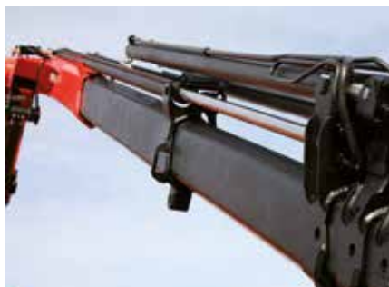
Sistema di sfilii telescopici a ridotta manutenzione Per meno costi e meno manodopera
