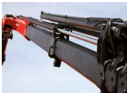
Sistema di sfilì telescopici a ridotta manutenzione
