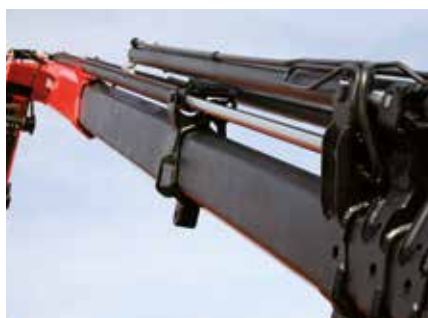
Sistema di sfili telescopici a ridotta manutenzione Per meno costi e meno manodopera
